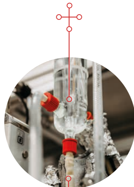
Wirbelschicht-Kristallisation im Technikum des Max-Planck-Instituts. Der Versuchsaufbau wird für die kontinuierliche Trennung von Enantiomeren chiraler Moleküle genutzt.
