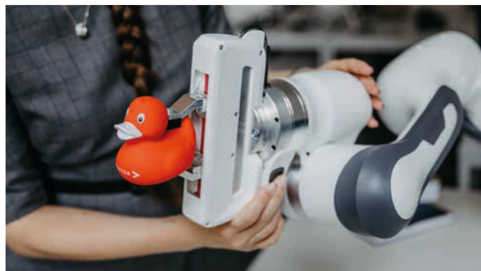
Regelungstechnik und Kraftsensoren ermöglichen es dem Roboter, autonom zu greifen und mit dem Menschen zu interagieren. Foto: Jana Dünnhaupt
