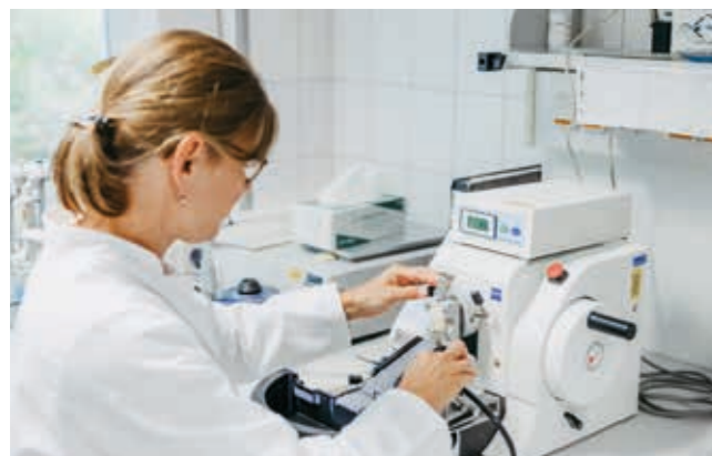
Mit dem Mikrotom können Dünnschnitte von Gewebeproben hergestellt werden, um u. a. Abriebpartikel aus den künstlichen Artikulationen zu identifizieren. Foto: Jana Dünnhaupt
