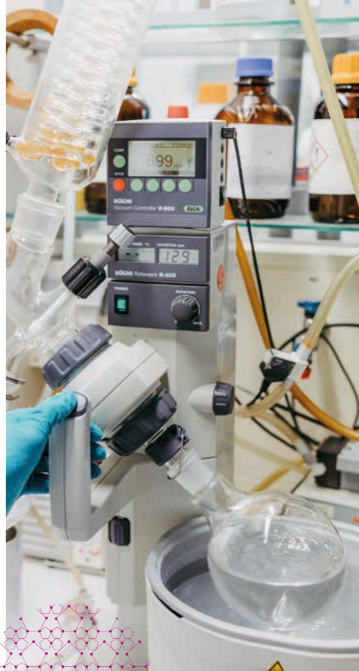
Einengen einer Lösung am Rotationsverdampfer Foto: Jana Dünnhaupt
