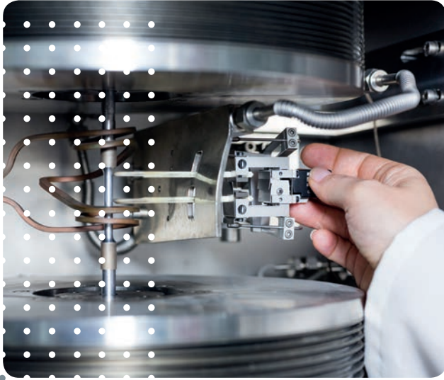
Probeneinbau für einen Versuch zur thermomechanischen Ermüdung bei hohen Temperaturen Foto: Stefan Berger
