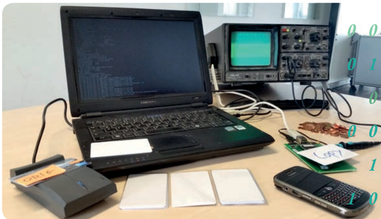
Mit einem NFC-Lesegerät können Kartendaten kontaktlos ausgelesen, verändert und gespeichert werden Bildquelle: AMSL Uni Magdeburg
