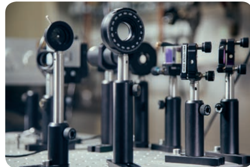
Laseroptiken zur Strahlformung des Anregungslasers Foto: Harald Krieg
