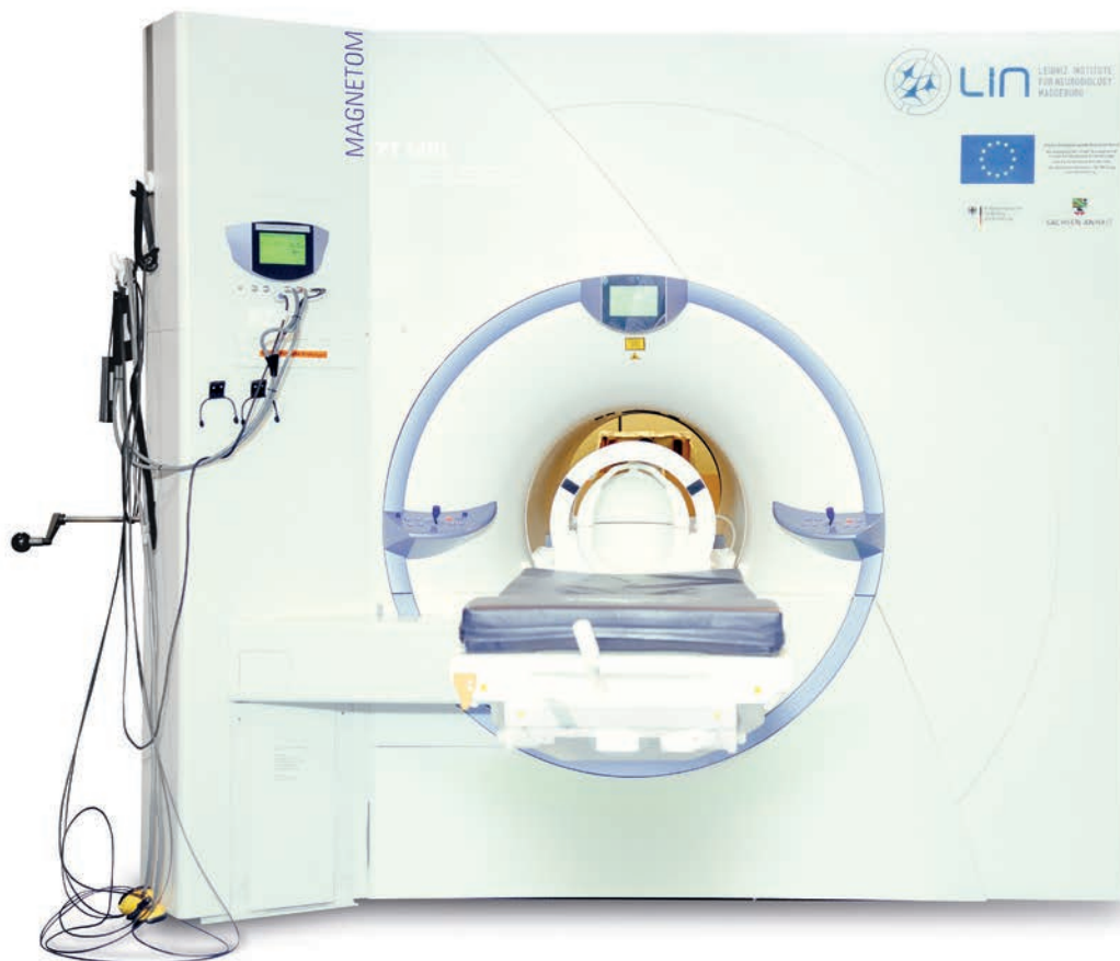
Der 32 Tonnen schwere 7-Tesla Ultrahochfeld- Kernspintomograph wurde in einem eigenen Gebäude auf dem Medizin-Campus installiert. Foto: Harald Krieg
