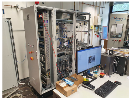
Abbildung 3.24: Teststand für die Untersuchung des URFC-Stacks
