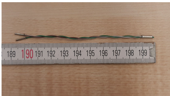
(a) 10 cm lange leerlaufende Zweidrahtleitung
