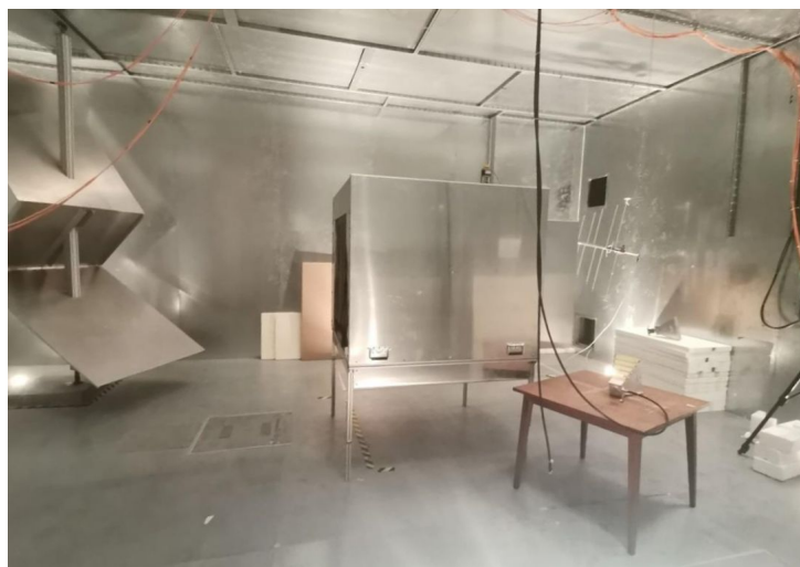
Abbildung 3.34: Messaufbau zur Bestimmung der Schirmdämpfung eines RFID-Tunnels mit Hilfe des Konzeptes von verschachtelten Modenverwirbelungskammern (Bildquelle: Hejbul Bahar Sanjib)
