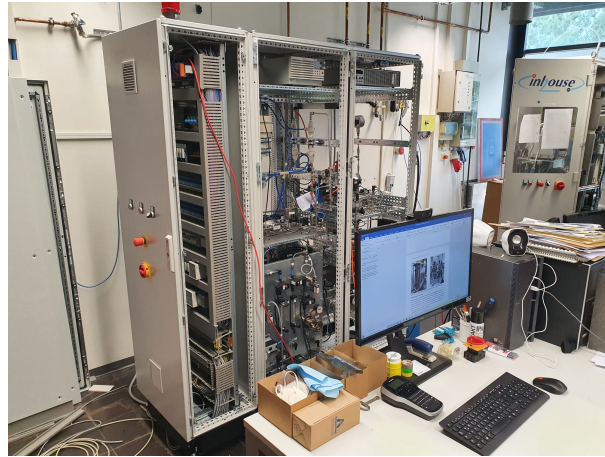
Abbildung 3.18: Teststand für die Untersuchung des URFC-Stacks
