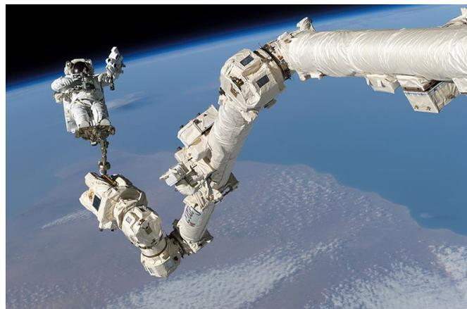
Abbildung 1. Verwendung des Canadarm2 als Stützvorrichtung für den Astronauten Stephen K. Robinson während eines Reparationseinsatzes, 2005. (Quelle: NASA, 2005 August. Web. URL [https://en.wikipedia.org/wiki/Mobile\\_Servicing\\_System#/media/File:STS-114\\_Steve\\_Robinson\\_on\\_Canadarm2.jpg](https://en.wikipedia.org/wiki/Mobile_Servicing_System#/media/File:STS-114_Steve_Robinson_on_Canadarm2.jpg), 19.03.2021)
