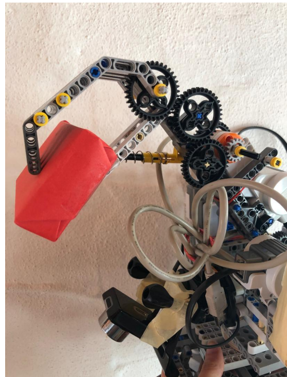
Abbildung 2. Greifarm mit aufgenommenem Objekt und Kamera
