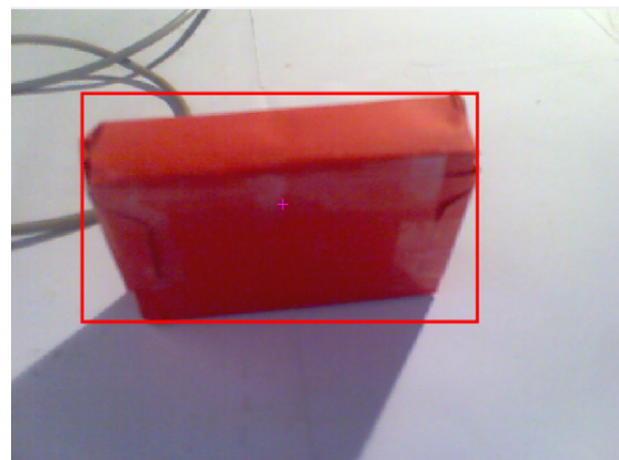
Abbildung 5. Bildverarbeitung: Erkennung des zugreifenden Objektes
