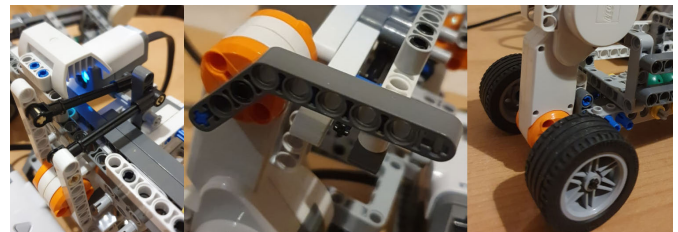
Abbildung 4. Die drei für den Farbsortierroboter verwendeten Motoren (links: Startmotor, mittig: Barrieremotor, recht: Transportmotor) [3]
