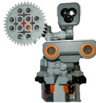
Abbildung 1: Sensorpaket mit Farbsensor sowie Ultraschall- und Tastsensor
