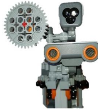
Abbildung 1: Sensorkopf mit Farbsensor sowie Ultraschall- und Tastsensor
