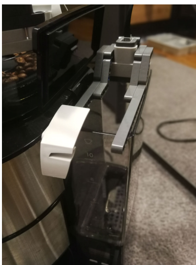
Abbildung 5. Wasservorrat mit angebautem Ultraschall-Sensor
