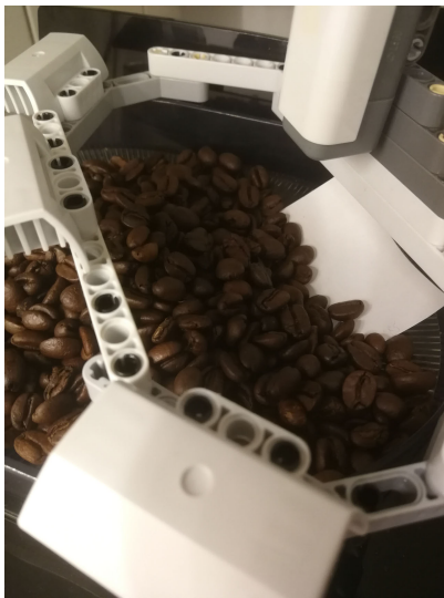
Abbildung 4. Bohnenvorrat mit angebautem RGB-Sensor
