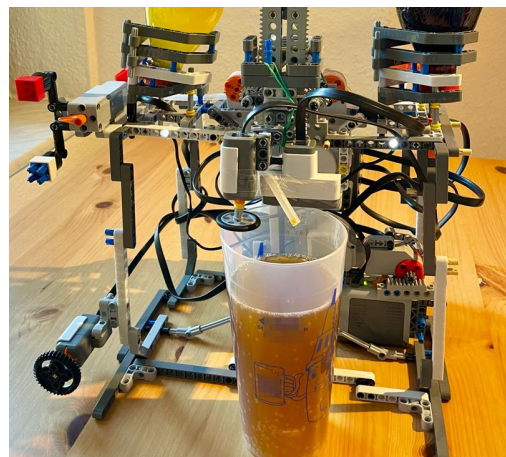
Abbildung 2: Aufbau des Getränkeautomaten mit Becher
