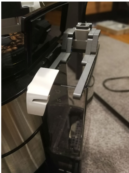
Abbildung 5. Wasservorrat mit angebautem Ultraschall-Sensor
