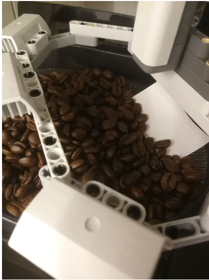
Abbildung 4. Bohnenvorrat mit angebautem RGB-Sensor
