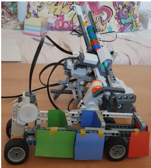
Abbildung 3. Aufbau des Farbsortierroboters [3]
