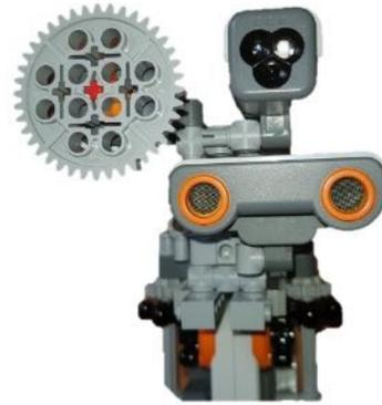
Abbildung 1: Sensorpaket mit Farbsensor sowie Ultraschall- und Tastsensor
