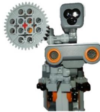
Abbildung 1: Sensorpaket mit Farbsensor sowie Ultraschall- und Tastsensor
