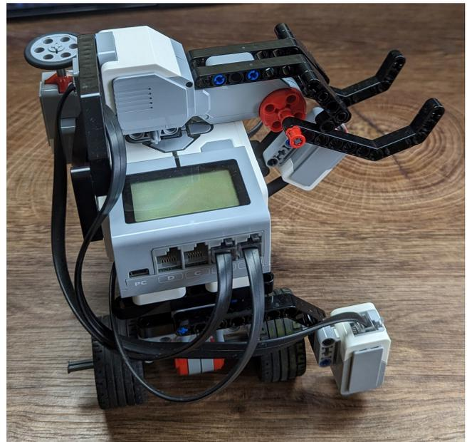
Abbildung 5. Farbsortierroboter mit reduziertem Greifer
