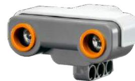
Abbildung 1: LEGO-Ultraschallsensor [1]
