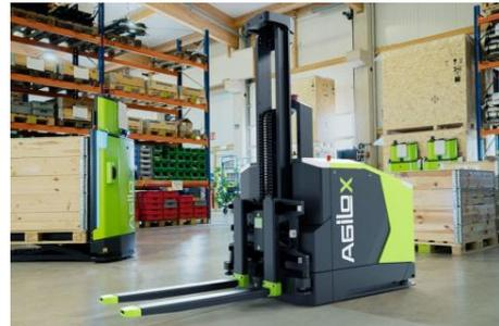
Abbildung [2]: Autonomer Gabelstapler der Marke Agilox
