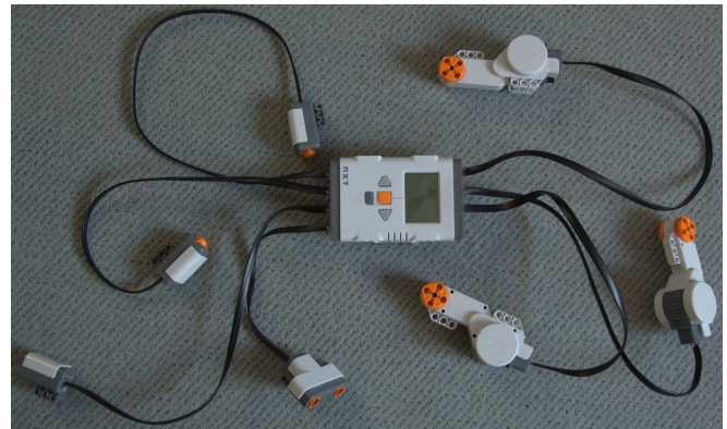
Abbildung 1. LEGO-Mindstorms-NXT-2.0-Stein mit über Kabel angeschlossenen Sensoren [1]
