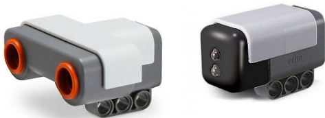
Abbildung 3. Links - Ultraschallsensor; Rechts - Farbsensor; Quelle [4]
