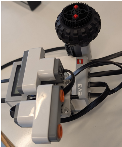
Abbildung 3. Ultraschallsensoren &amp; Not-Aus-Schalter montiert auf EV3
