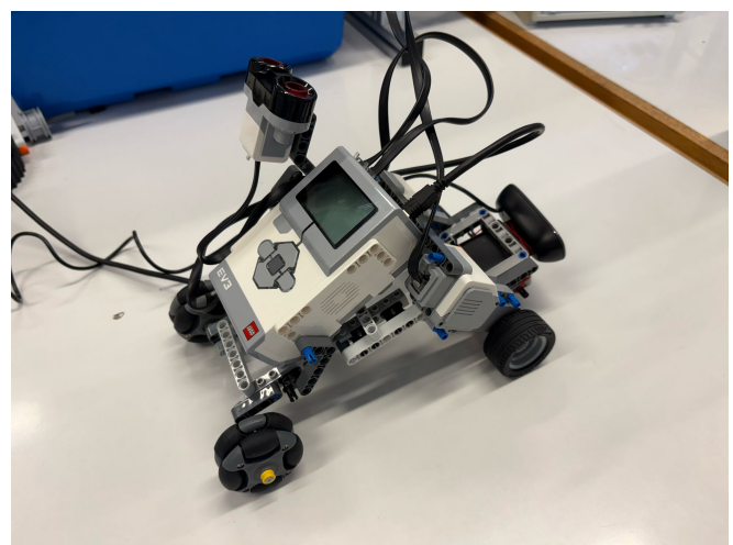
Abbildung 1: Erste Konstruktion mit zwei Omniwheels und USB-Webcam
