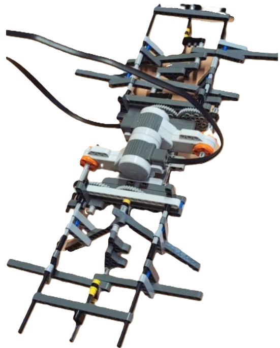
Abbildung 4. Motor, Kurbelwelle und Zahnräder Version 1
