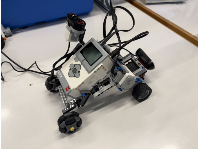
Abbildung 1. Erste Konstruktion auf vier Rädern mit zwei Motoren und USB Webcam
