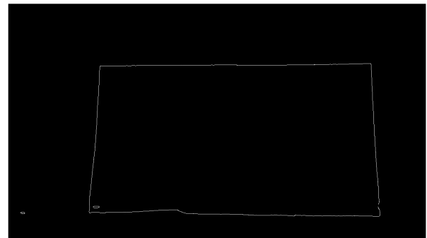
Abbildung 5. Ausgang nach Kantenerkennung mit Canny-Methode und Schwellwert von 0,7
