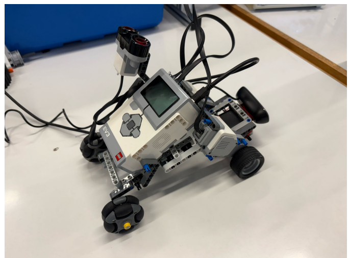
Abbildung 1: Erste Konstruktion mit zwei Omniwheels und USB-Webcam
