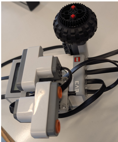
Abbildung 3. Ultraschallsensoren &amp; Not-Aus-Schalter montiert auf EV3
