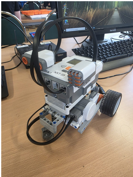
Abbildung 1. Hardwareaufbau von „Wall-E“: Antriebsmotoren, Ultraschallsensor (Frontmontage unter Kabelzuführung, über NXT-Baustein) und passives Stützrad. Der Ultraschallsensor ist an den Öffnungen erkennbar und liegt neben dem rechteckigen Geräuschsensor.
