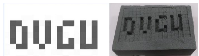
Abbildung 1: links: beispielhafte JPEG Datei, rechts: Gestanztes Relief.
