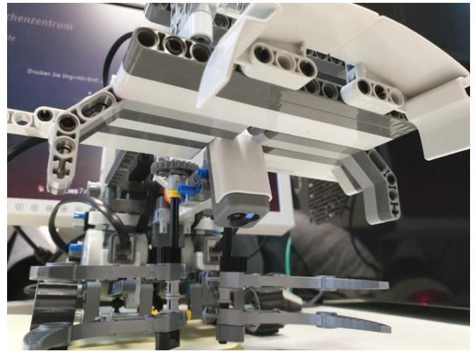
Abbildung 3: Farbsensor und die Decke
