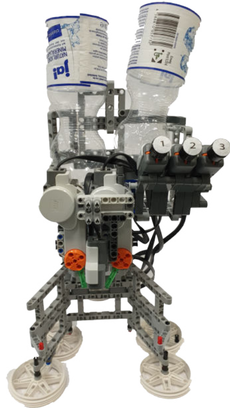
Abbildung 1. Die Vorderseite des Cocktailmixers, von oben nach unten, mit Flüssigkeitstanks, nummerierten Tastern, Servomotoren, Distanzsensoren und Ausschank.
