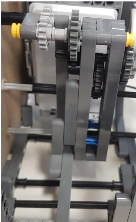
Abbildung 4: Zahnradsystem für die Zeiger
