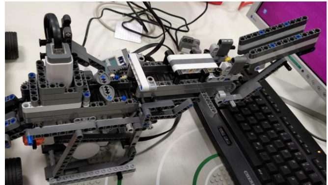
(Abb. 5) Hier gut zu erkennen, die Abschottung des Farbsensors und die Dächer zur Steinvereinzlung
