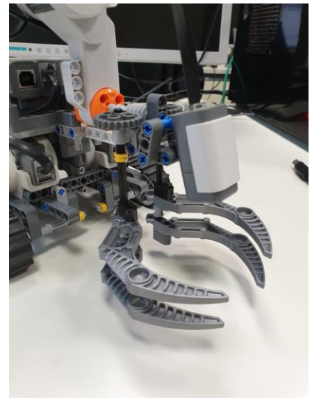
Abbildung 1: Greifer und Farbsensor
