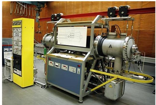
Abbildung: 1-Atomuhr CS2 der PTB in Braunschweig [2]
