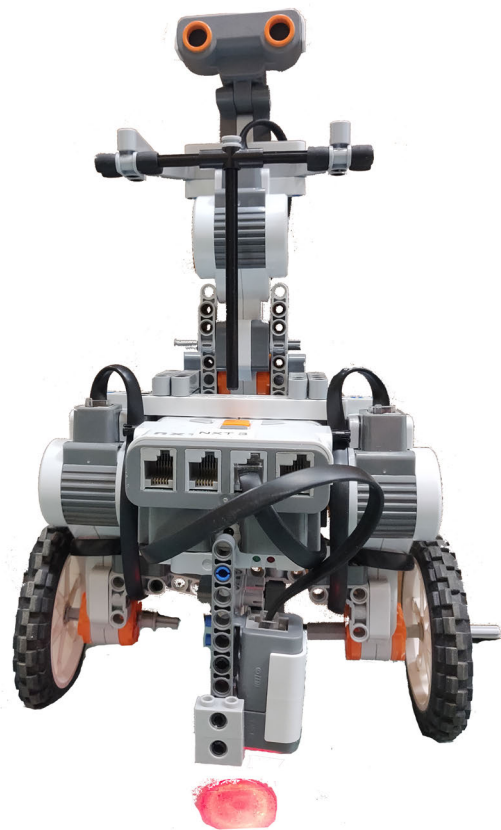
Abbildung 1. Balance Bot aus dem Lego-Projektseminar 2019
