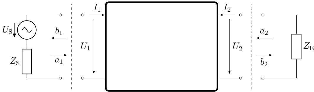
Abbildung 3.8: Ersatzschaltbild einer Leierschleife im Empfangsfall und beliebiger Vierpol.
