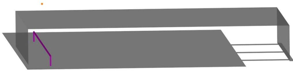
Abbildung 5.10: Simulationsmodell des Tischaufbaus für die Variante Einzeldraht (lila) mit Metallhaube und Feldaufpunkt (orange). Metallhaube und Tischplatte sind elektrisch leitfähig miteinander verbunden.
