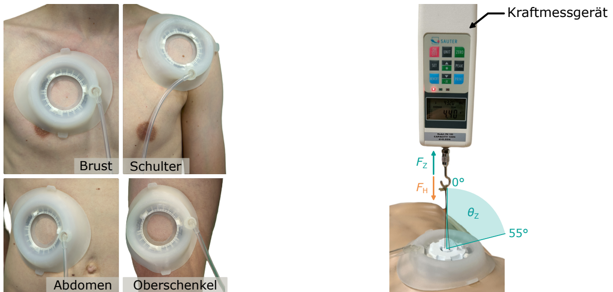
Abbildung 4.33: Versuchsaufbau zur Evaluation der Haltkräfte des Robotik-Patienten Interfaces. (links) Positionierung an verschiedenen Körperbereichen auf der Hautoberfläche. (rechts) Messung der notwendigen Zugkräfte F_z mit einem Kraftmessgerät aus verschiedenen Winkeln \theta_z bis das Robotik-Patienten Interface nicht mehr haftet.
