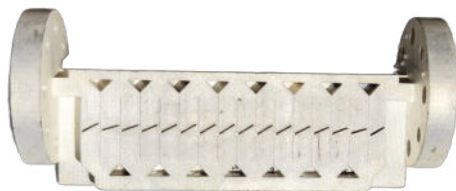
Abbildung 5.34: Foto der finalen serpentinenförmigen Antenne mit vergrößerter Hohlleiteröffnung und Versilberung mittels Peristaltikpumpe.
