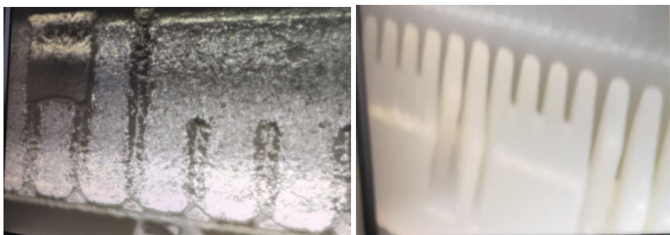
(a) Verschmolzene Schlitzte zwischen den Ridges (b) Geöffnete Schlitzstruktur nach Trennung, Reinigung und Aushärten der Antenne in zwei Teilen.
