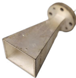
Abbildung 5.9: Additiv gefertigte Hornantenne mit einem simulierten Gewinn von 20 dBi nach dem chemischen Versilberungsprozess.
