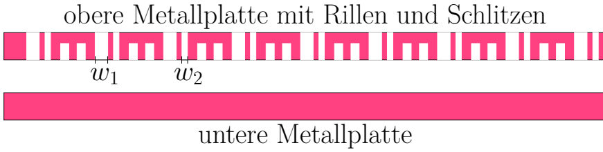
Abbildung 5.13: Modifizierte Geometrie der Slow-Wave-Leckwellenantenne mit unterschiedlich breiten Schlitten zur Unterdrückung des Open-Stopbands.
