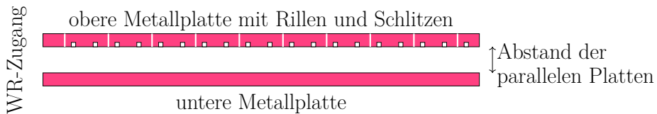
Abbildung 4.14: Schematischer Aufbau einer periodischen Rillen-Leckwellenantenne in Parallelplattenstruktur.
