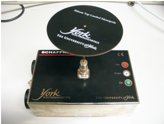
Abbildung 3.10: Der Rauschgenerator »CNEIII« mit 100 mm Monopolantenne.
