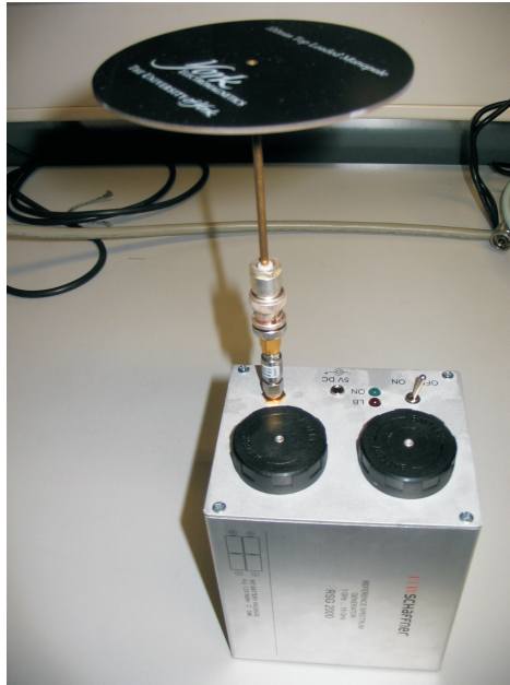
Abbildung 3.11: Kammgenerator »RSG2000« mit Abschwächer und aufgesetzter Monopolantenne.
