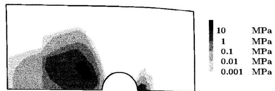
Bild 8d. Isotrope Verfestigung der Außenwand nach 10433 Zyklen
