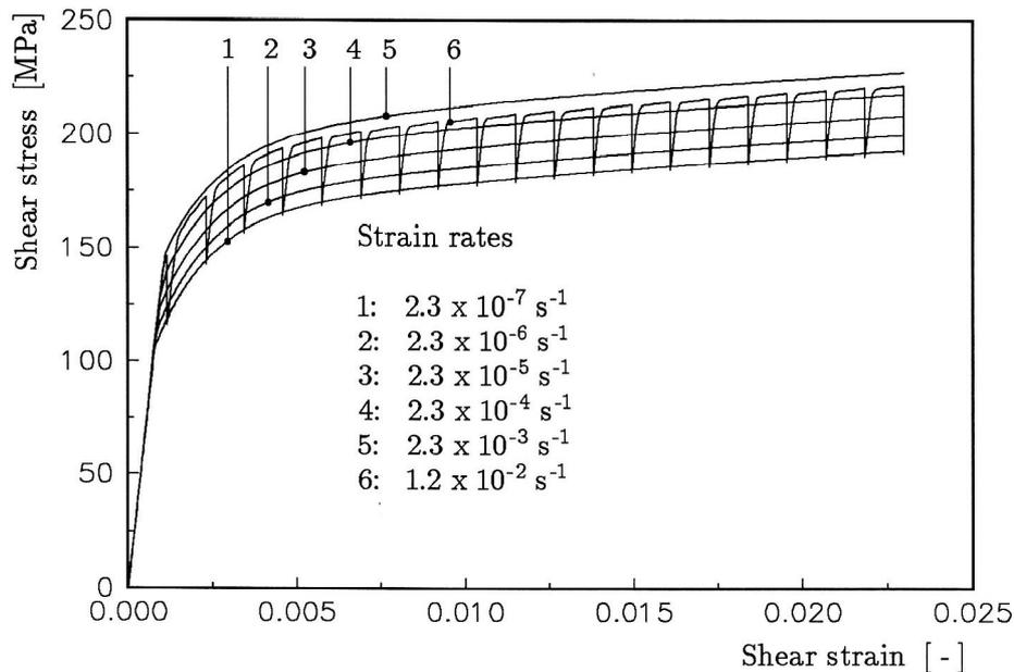
Bild 4. Spannungsantwort des vollständigen Modells auf monotone Dehnungsprozesse mit verschiedenen Dehnungsgeschwindigkeiten und Haltezeiten
