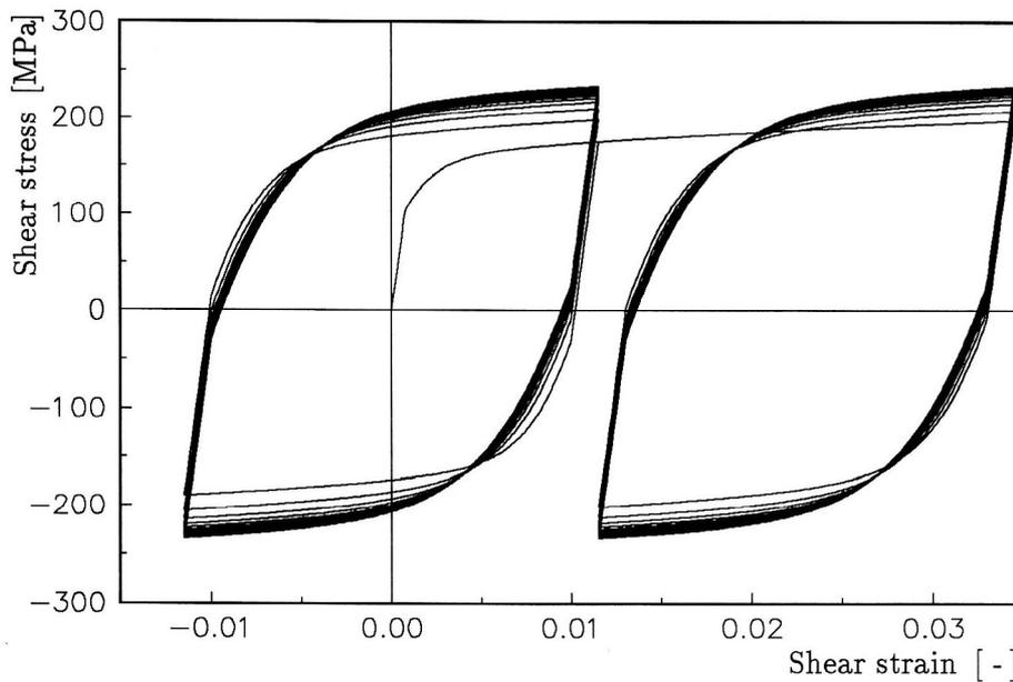
Bild 1. Antwort der Gleichgewichtsspannung auf einen zyklischen Dehnungsprozeß mit zwei unterschiedlichen Mitteldehnungen
