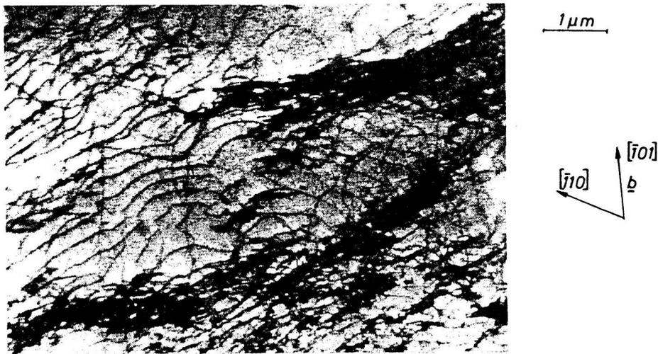
Bild 3. Versetzungsstruktur im Cu Einkristall im Bereich II nach Mughrabi (in Kröner und Theodosiu (1974))
