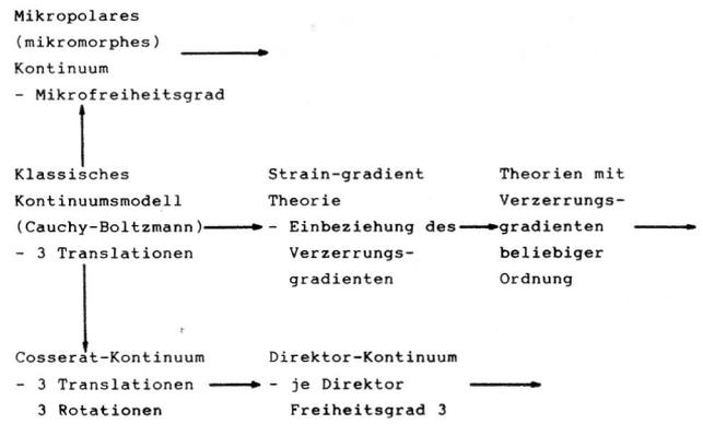
**Bild 7a:** Kinematische Erweiterungen des klassischen Kontinuumsmodells (bezogen auf dreidimensionale Räume)
