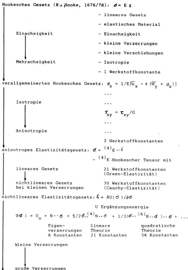
**Bild 6:** Beispiel für die induktive Methode (elastisches Werkstoffverhalten)
