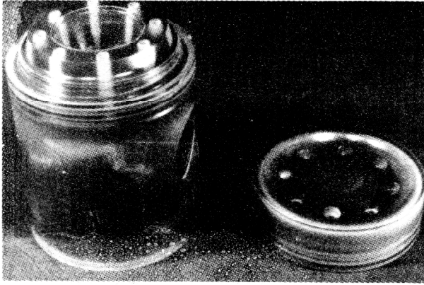
Bild 4 Modell des Kolbenunter- und Kolbenoberteils
