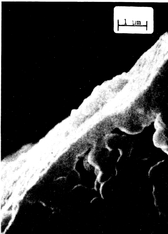
Bild 1 Membranbildung in der Hülle des PVC (S) nach [3]
