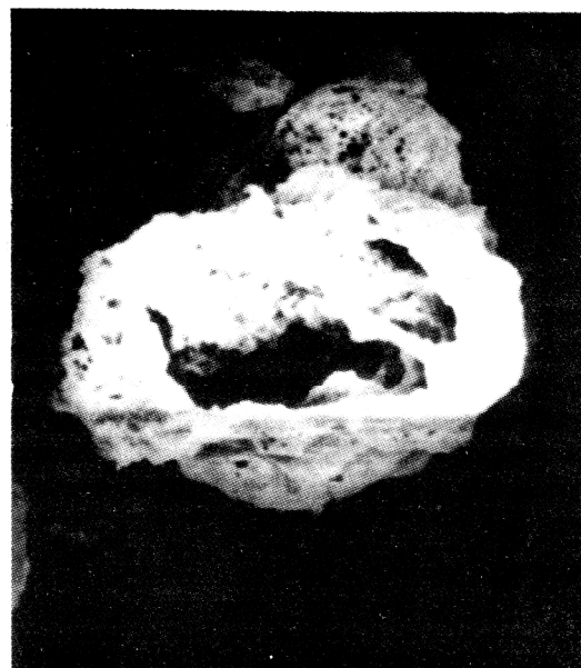
Bild 2 Hüllenbildung beim PVC (S) bei einem Umsatz von 4,9 % und einer Reaktionstemperatur von 340 K (300fache Vergrößerung)
