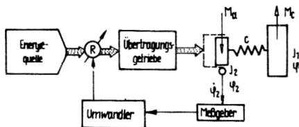
Bild 1: Berechnungsmodell des geregelten Antriebssystems
