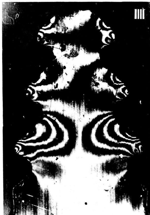
Bild 12 Isothermenfeld des entlasteten Tannenbaumprofils kurz vor Erreichen der Traglast Schaufellast/Modelldicke: 1.96 kN/mm a) Verschiebung u_2 (in Beanspruchungsrichtung) b) Verschiebung u_1 (quer zur Beanspruchungsrichtung)
