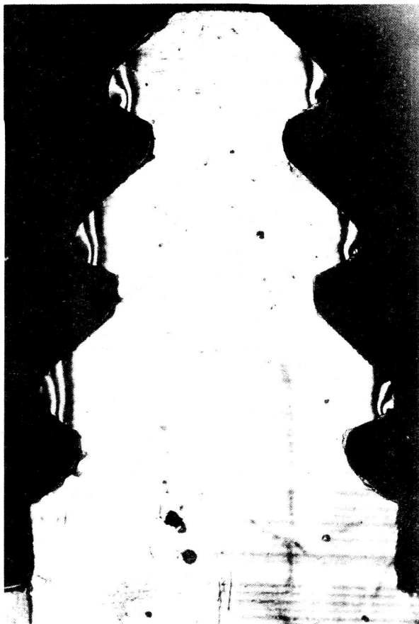
Bild 11 Isothermenfeld nach Entlastung der Tannenbaum-Verbindung. Objektraster: Kreuzraster, 100 Linien/mm, mit weichgemachtem Epoxidharz auf das Modell übertragen; Bezugsraster: Linienraster, 100 Linien/mm, ORWO-Fotoplatte LP 2 Schaufellast/Modelldicke: 1.23 kN/mm
