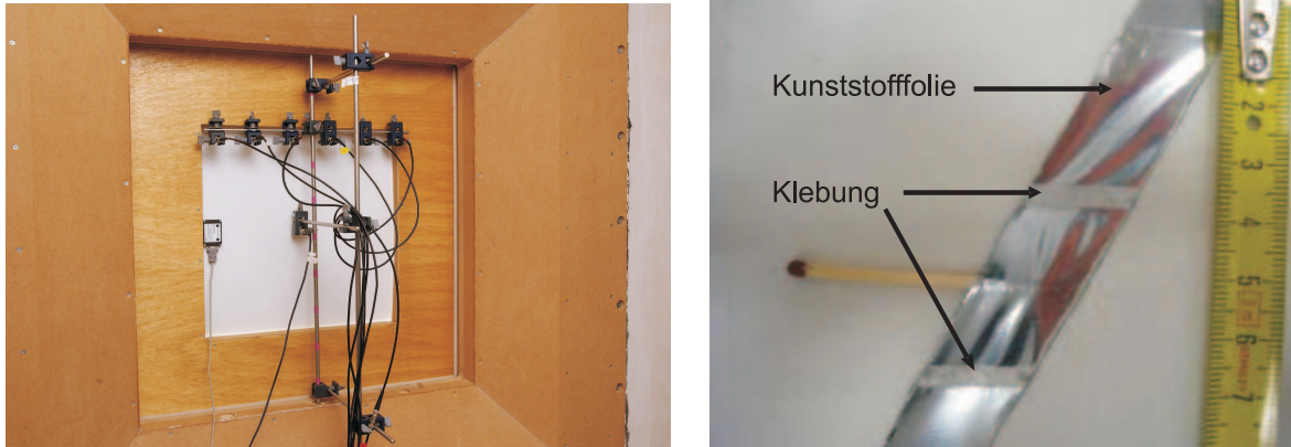
Bild 1: Flachlautsprecher mit Mikrofonfeld (links) und Bestandteile des Lautsprechers (rechts)
