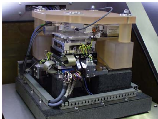
Bild 1. Nanopositionier- und Nanomessmaschine (li.) mit den wesentlichen Baugruppen zur abbefehlerfreien Messung (re.)
