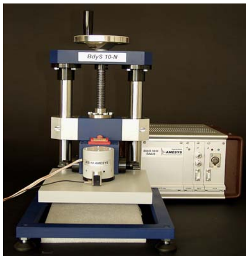
Bild 3. Versuchsaufbau zur Bestimmung der dynamischen Parameter der Schwingungsisolationsschicht (li.) und Inertialkrafterreger zur Erzeugung harmonischer Testsignale (re.)
