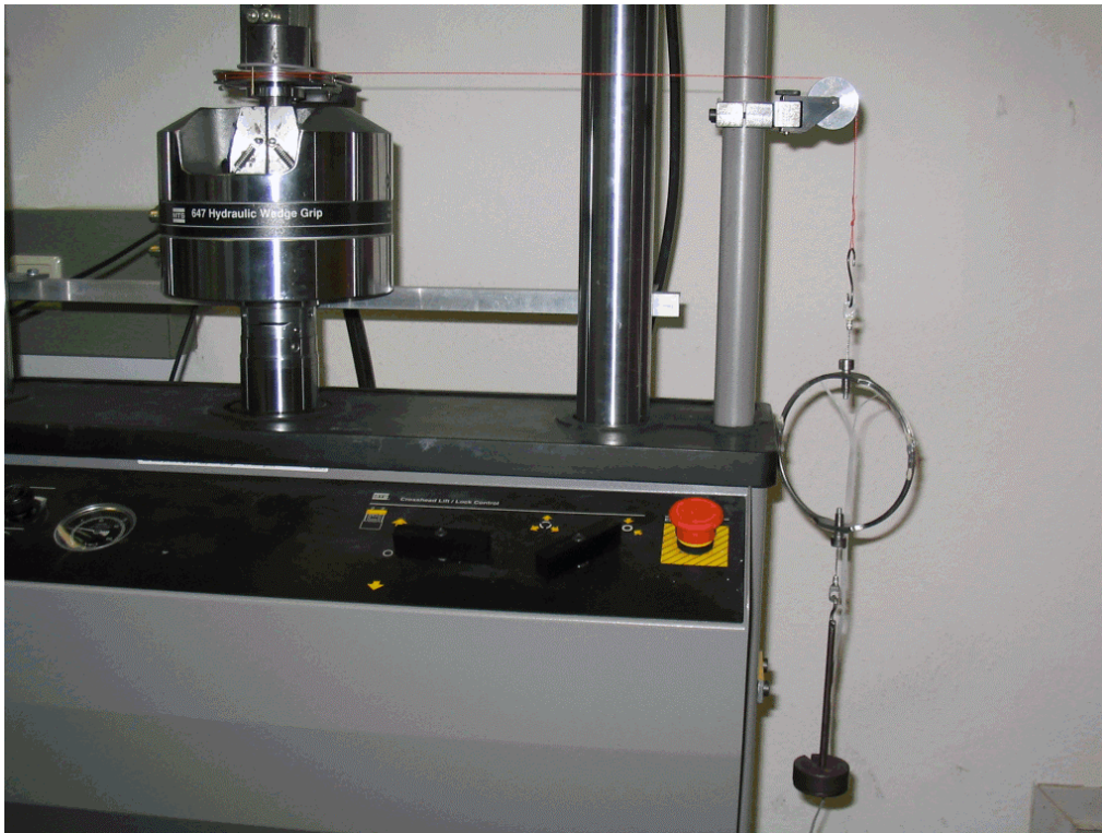
Bild 8. Einrichtung zur Einleitung des Torsionsmomentes beim Torsionsversuch
