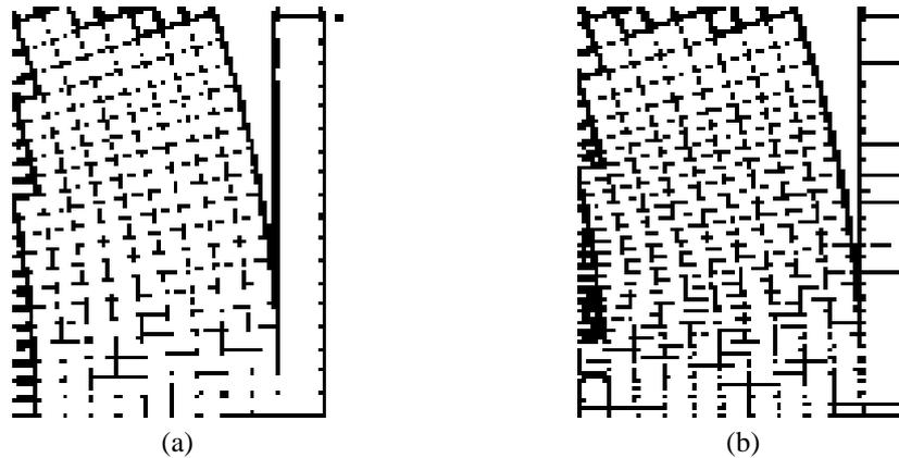
Bild 4. Die FE Unterteilungsvarianten der Kontaktzone
