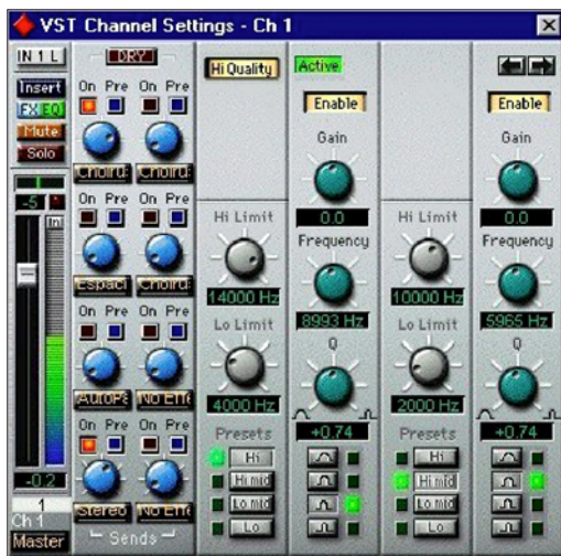
Abb. 15 Pegel, Effektwege und Frequenzgang-Entzerrer für die Gesangspur (Ch 1)
