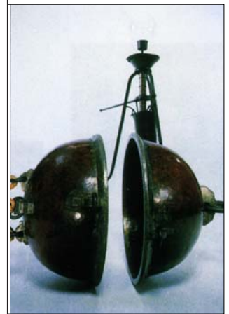
Die Original-Halbkugeln für den berühmten und unverändert populären Halbkugelversuch Otto von Guericke's.
