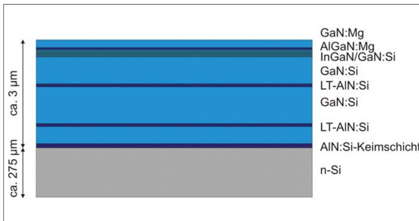
Abb. 10 Aufbau der LED-Struktur: auf einem hochleitfähigem n-Typ-Silizium-Substrat wird eine ca. 20 nm dicke Aluminiumnitrid-Keimschicht bei niedrigen Temperaturen abgeschieden. Darauf kommt ein siliziumdotierter Galliumnitrid-Puffer bei Wachstumstemperaturen von ca. 1 050 °C, der mit Hilfe der Niedertemperatur(LT)-AlN:Si-Zwischenschichten am Reißen gehindert wird. Als aktive Schicht werden bei niedriger Temperatur (700-800 °C) Indiumgalliumnitrid- bzw. Galliumnitrid-Multiquantumwells abgeschieden (5-mal). Hier ist nur die Galliumnitrid-Barriere mit Silizium dotiert. Als Deckschicht und für den p-Typ-Kontakt werden darauf ca. 15 nm \text{Al}_{0,15}\text{Ga}_{0,85}\text{N:Mg} und ca. 200 nm GaN:Mg abgeschieden.
