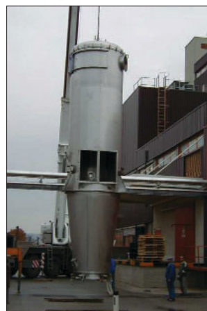
Abbildung 3 Beispiel eines industriellen Wirbelschichtapparats der Firma AMMAG GmbH, Gunskirchen/Österreich, beim Transport in die Produktionshalle. Der hier gezeigte, mehr als 10 m hohe Apparat ist nicht nur zur Trocknung, sondern insbesondere zur Sprühgranulation geeignet. Dabei werden mit Hilfe einer eingesprühten Lösung relativ kleine Teilchen in wesentlich größere Partikeln mit der erwünschten Konsistenz umgewandelt. Wirbelschichtapparate werden von vielen Herstellern angeboten und können von der hier gezeigten Form erheblich abweichen, z. B. flach und länglich sein.
